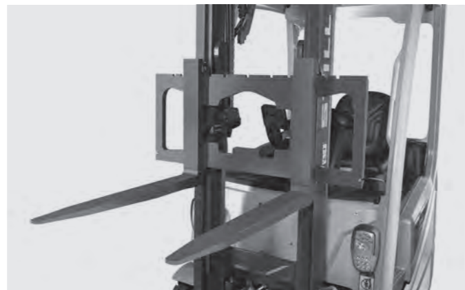
Visão otimizada das pontas do garfo para carga e descarga de paletes
