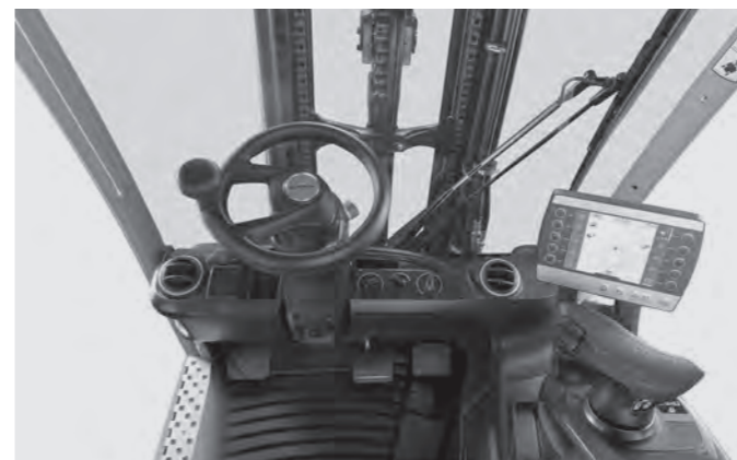
Espaço de trabalho com monitor e unidades de controle, Joystick 4Plus e aquecimento
