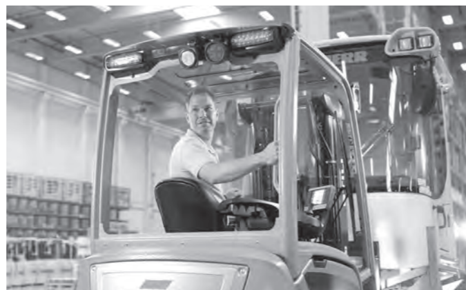
Assento giratório com vista para trás e alça de apoio na proteção do operador
